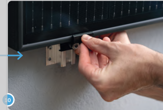
10 Die Klemmen werden von oben bzw. vorne in die Schienen gedrückt. Beim Hinunterdrücken dreht sich die Feder um 90° und schnappt ein.
