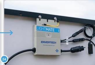
Der Wechselrichter wird schon am Panel festgeschraubt von uns geliefert.
