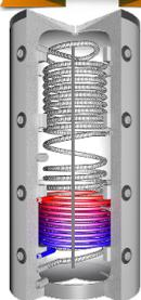
**EHSWP Hygiene-Schichtenkombispeicher - Hochleistung bzw. für Wärmepumpen**, Heizungspufferspeicher (3 bar) mit Glattrohrwärmetauscher, innen roh, hygienisch, legionellenfreie Wasseraufbereitung mit sehr hoher Zapfleistung, Trinkwassererwärmung im Durchlaufprinzip (Edelstahlwellrohr V4A 1.4404, 6 bar), inkl. Fühlerklemmleiste zur variablen Positionierung der Fühler.
