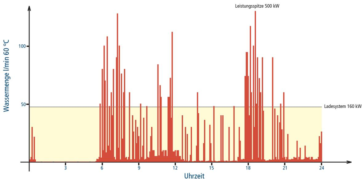
Die unitec Ladestation wird anhand der Leistungsspitzen und Beachtung der Grundlast ausgelegt. Somit wird eine hohe Energieeffizienz in Verbindung mit einem hohen Komfort der Gesamtanlage gewährleistet.
